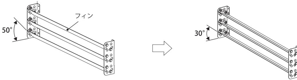
1. フィン取り付けの角度調整用ナイラッチ 6 か所のプランジャーを引っ張り、ナイラッチを非固定状態にして取り外してください。
