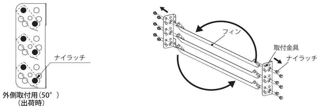
3. 取付金具のフィン取付穴にフィン(50° または 30°)を合わせ、ナイラッチのプランジャーを「カチッ」と音がするまで押し込み、取付金具とフィンの固定を行ってください。
