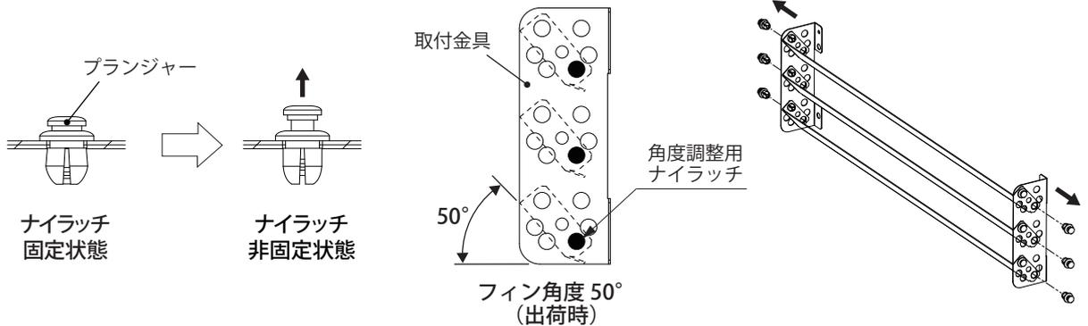
2. 取付金具のフィン角度が 30° になる角度調節穴にフィンを合わせ、角度調整用ナイラッチのプランジャーを「カチッ」と音がするまで押し込み、取付金具とフィンの固定を行ってください。
