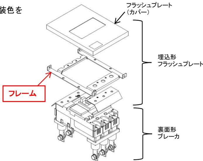
(図1) 埋込形フラッシュプレート+裏面形ブレーカ
