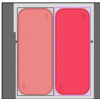
加工穴が離隔不足
