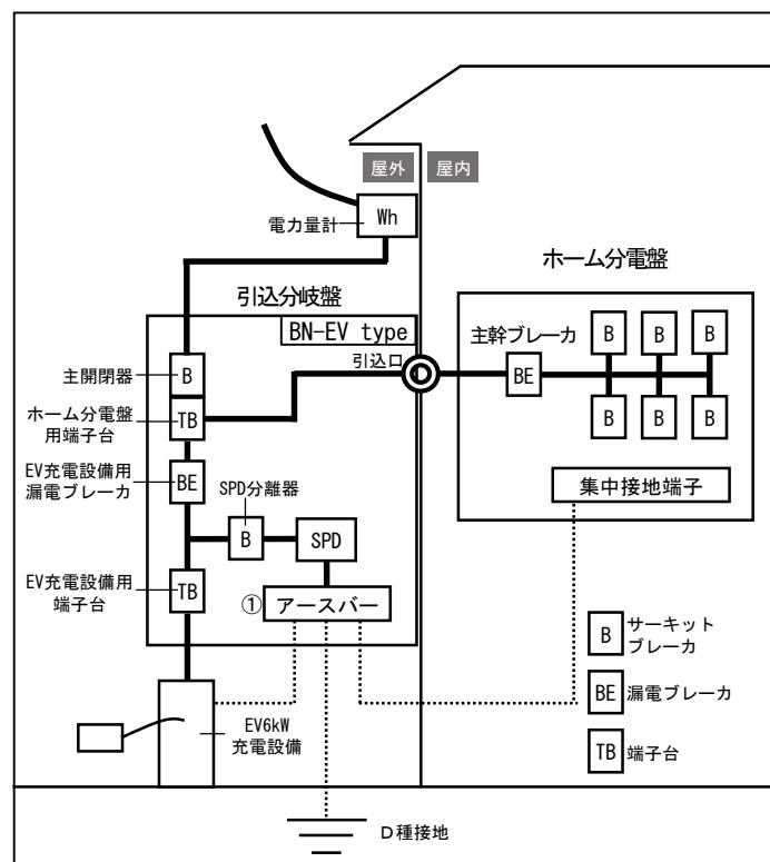
①有効な雷保護が可能となるよう、ホーム分電盤、EV充電設備の各接地線を本製品のアースバーに接続してください。
