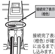
接続完了表示(橙色)が確実に出るまで差し込みます。
