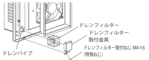
図11 ドレンフィルター取付方法
