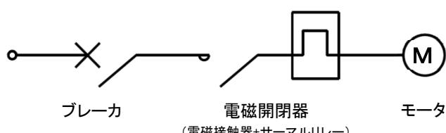
この選定表では電動機の過負荷保護を電磁開閉器により行い、回路の短絡保護をブレーカで行います。
